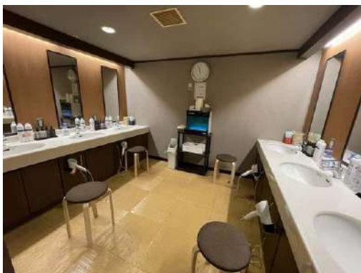
脱衣室洗面台高さ62cm
